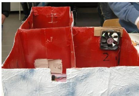
Figura 12: Modello di casa per studiare l'isolamento termico. La ventola raffredda una delle "stanze"
