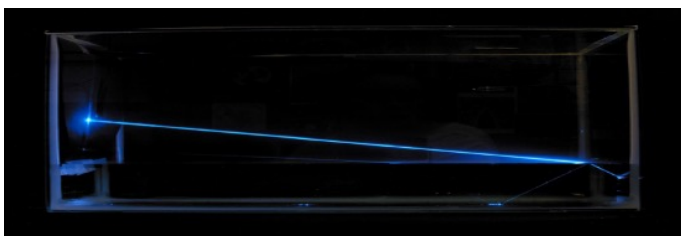
Figura 6: Propagazione della luce in un vasca parzialmente riempita d'acqua
