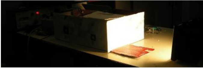
Figura 13: Esempio di setting sperimentale per studiare l'isolamento termico di un modello di casa. Una stanza è coperta da un "soffitto" in polistirolo mentre le altre sono scoperte. La casa è illuminata da una lampada da 150 W che rappresenta il Sole.
