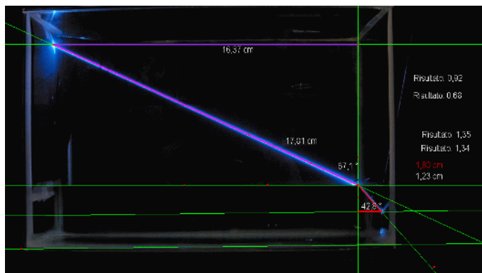
Figura 7: Misura degli angoli di incidenza e di rifrazione mediante il software Cabri
